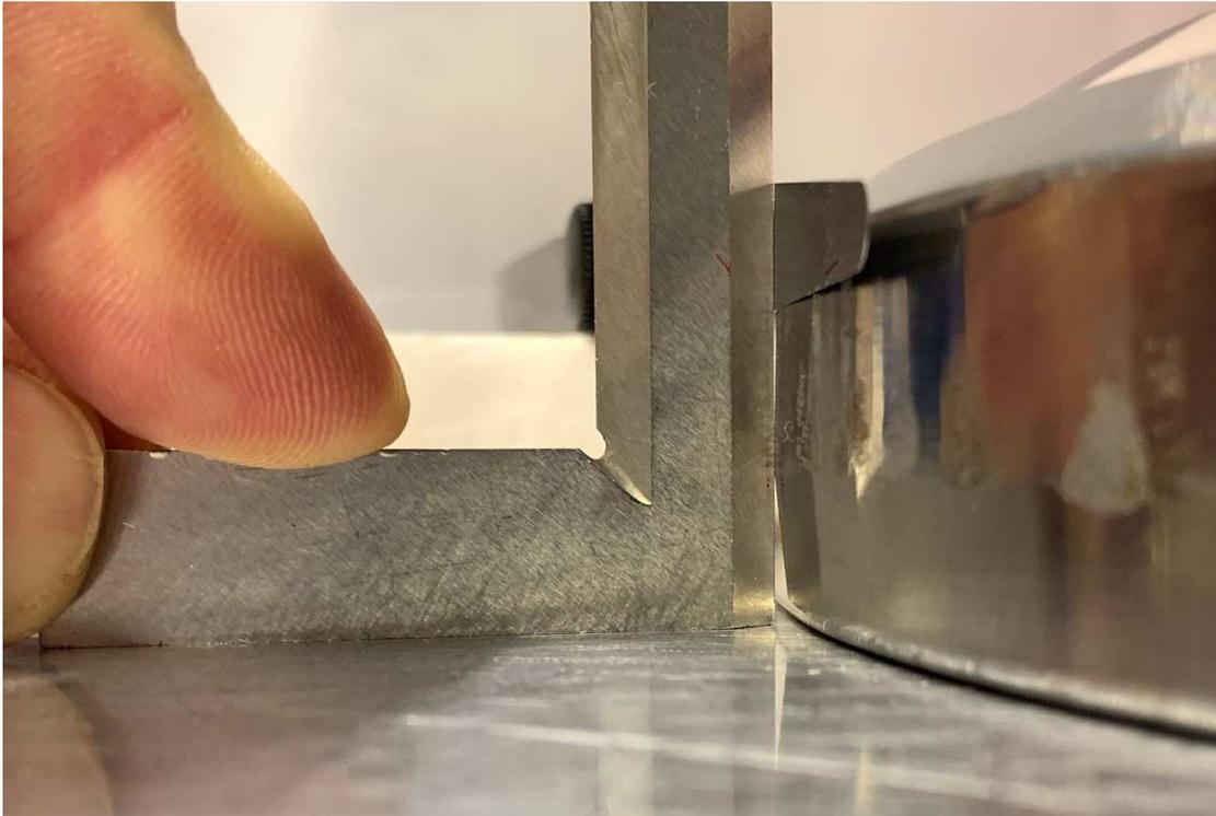
Dieser Eisstock ist nicht regelgerecht, da die 0,1mm Fühlerlehre einige mm einfällt! *D. h. die Fühlerlehre rutscht in den Spalt ein.*
